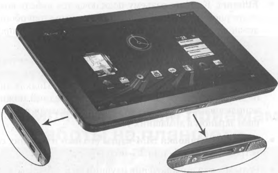
Рис. 1.2. Разъемы на торцах планшетного компьютера
