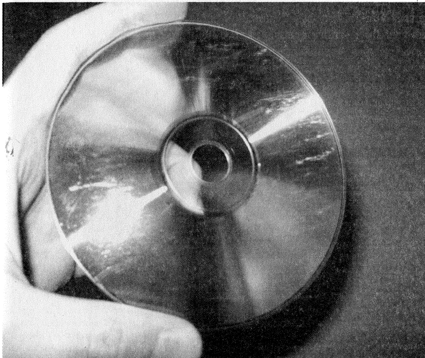
Рис. 10.3. Наибольшую опасность представляют концентрические царапины (по кругу), поэтому протирать диски рекомендуется от центра к краю
