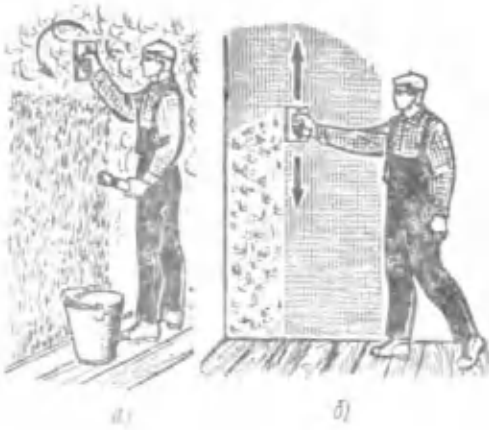
Рис. 22. Затирка штукатурки терками вкруговую (а) и вразгонку (б)
