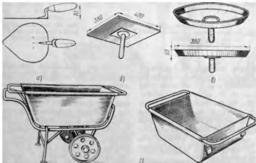
Рис. 17. Инструменты для нанесения раствора вручную: а — штукатурная кельма, б — деревянный сокол, в — тарельчатый сокол, г — штукатурные ящички
