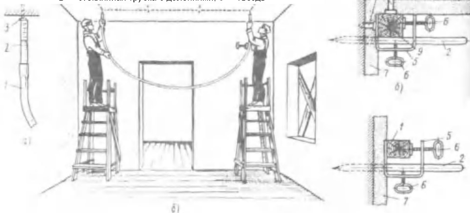
Рис. 14. Зажимы для крепления правил: а — простой, б — сложный. 1 — правило, 2 — штыри, 3 — лапки, 4 — балка, 5 — хомут-скоба, 6 — винт, 7 — штукатурный намет, 8 — марки, 9 — угловой деревянный маяк
