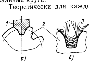
Рис. 36. Обработка зубьев методом копирования (а) и методом обкатки (б)
