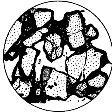
Рис. 12.3. Микрофотография шлифа шлифовального круга на заданном уровне сечения 50 мкм:
