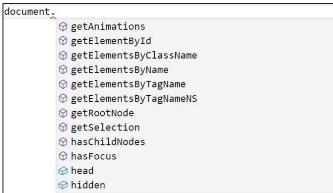
Рис. 1.28. Всплывающая подсказка со списком свойств и методов объекта в JavaScript-файле
