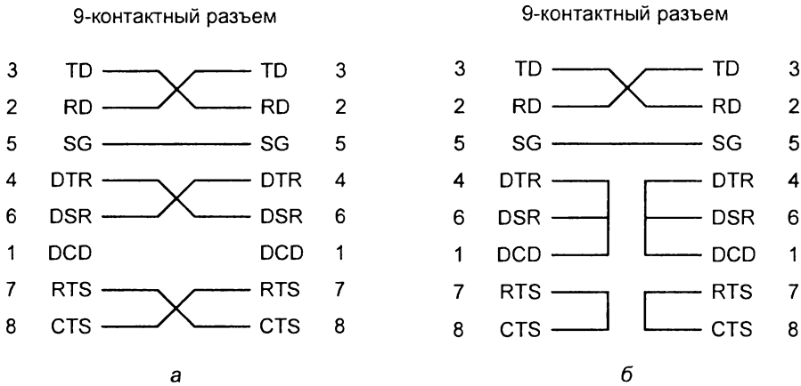
Рис. 2.3. Нуль-модемное соединение: а — полнофункциональное соединение, б — упрощенный вариант
