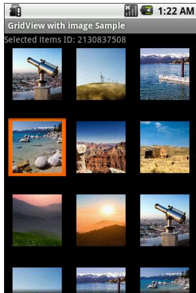
Рис. 7.9. Приложение с виджетом GridView, отображающим графику
