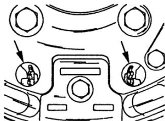
Рис. 2.8.15. Установочные шестерни прилегания тормозных колодок к тормозному барабану (стрелками показано положение установочных шестерен регулировочного механизма фирмы Mercedes-Benz)
