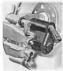
Рис. 2.8.1. Механизм стояночной тормозной системы автомобиля AUDI
