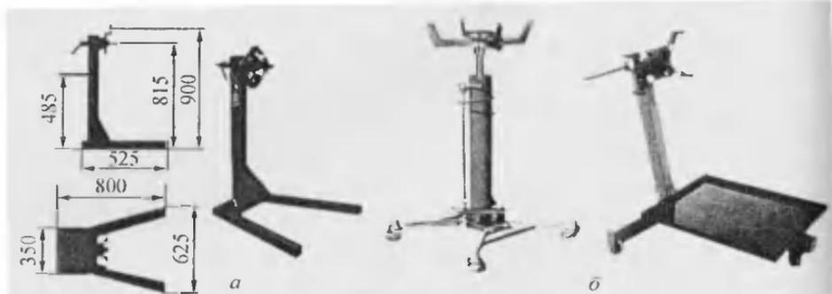
Рис. 3.5.1. Стенды для снятия и установки коробок передач (а), разборки и сборки редукторов ведущих мостов (б)
