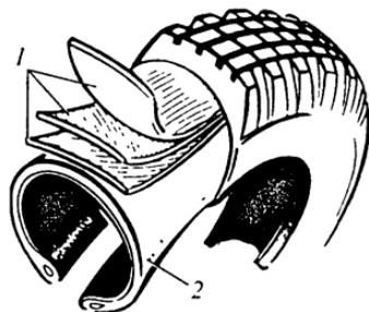
Рис. 4.6.5. Радиальная шина: 1 — слой брекера; 2 — каркас с радиальным расположением нитей корда
