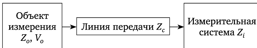
Рис. 3.6. Энергетическое согласование передачи измерительных сигналов по соединительным линиям
