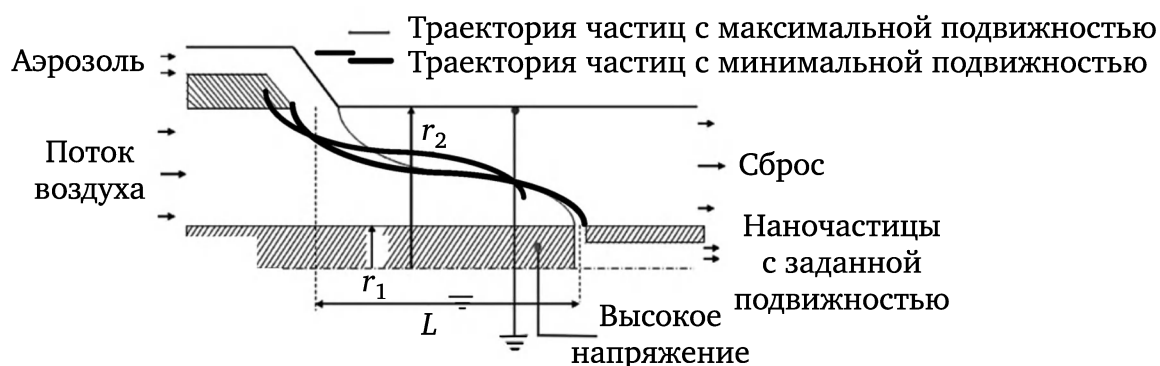
Рис. 5.20. Схема дифференциального анализатора подвижности частиц
