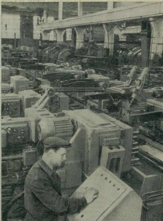
Вот новорожденная автоматическая линия. Она изготовлена на Московском станкостроительном заводе имени Серго Орджоникидзе и уже прошла испытания. В линии 12 станков-братьев. Их специальность — обрабатывать блоки цилиндров мотора. Отсюда, из этого цеха, их повезут в Харьков на тракторный завод «Серп и молот». Станки-автоматы будут сверлить, растачивать, фрезеровать, делать нарезку; что ни час, то сорос блоков готовы, а в цехе всего два человека наблюдают за работой автоматической линии.
