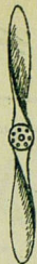
Пропеллер имеет право называться винтом. Он тот же клин с его наклонной плоскостью.
