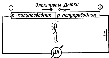
Рис. 53. Образование термоэлектродвижущей силы
