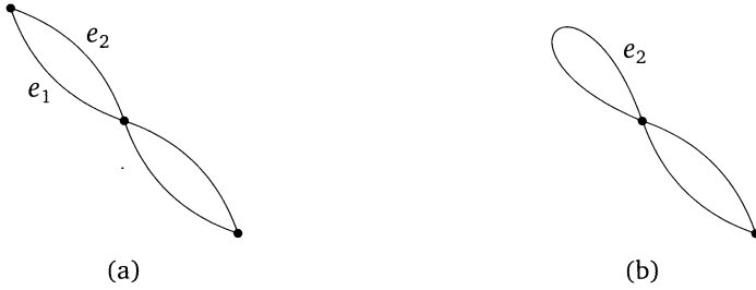
Рис. 2.21. Операция стягивания ребра: (a) исходный граф G ; (b) граф G/e_1
