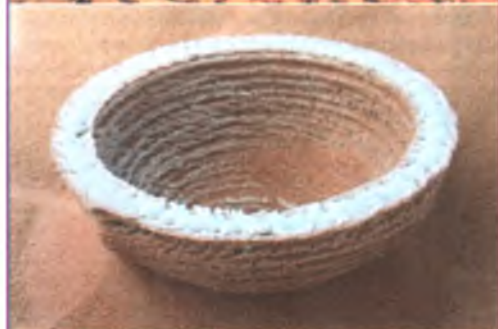
Принтер Solar Sinter (вверху), созданный Маркусом Кайзером, использует энергию концентрированных солнечных лучей, чтобы спекать песчинки и создавать тем самым трехмерные объекты — такие, например, как емкость для воды (внизу)
