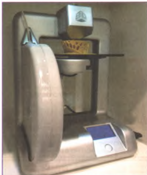
Внешний вид 3D-принтера Cube и печать изделия
