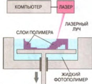
Луч УФ-лазера, согласно заданной программе, фокусируется на поверхность платформы, покрытой тонким слоем жидкой светочувствительной смолы. В результате фотополимеризации образуется первый слой искомого объекта
