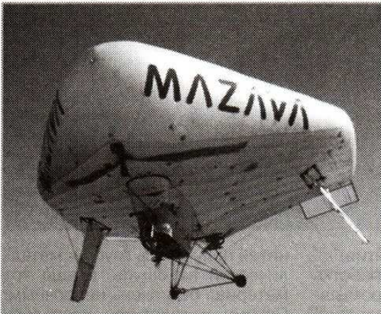
Энергию дирижаблям Solar Ship поставят солнечные батареи, размещенные «на спине» этих воздушных судов
