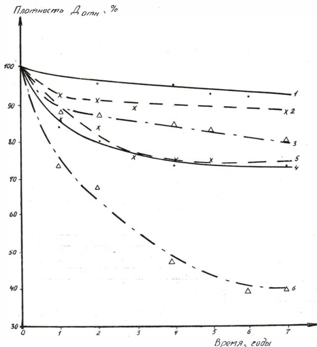
Рис. Изменение оптических плотностей на кинодокументах, изготовленных на киноплёнках типа ДС и ЛН (кривые 1, 2, 3) и ЦП-8Р (кривые 4, 5, 6) при архивном хранении: 1, 4 — желтый краситель; 2, 5 — пурпурный краситель; 3, 6 — голубой краситель
