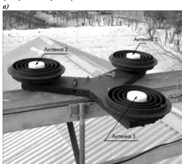
а) антенная система аппаратуры МРК-32; б) расположение НКА во время проведения эксперимента.
