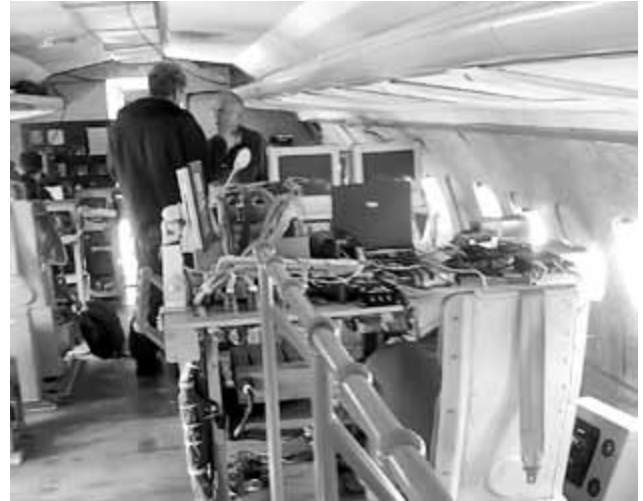
Рис. 7. Летящая лаборатория Ту-154М, испытательное оборудование
