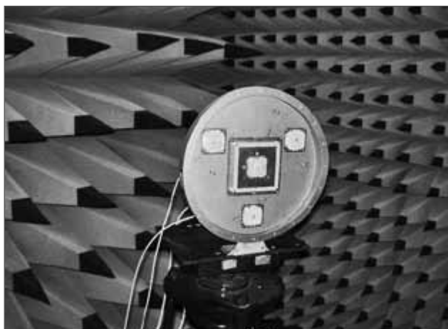
Рис. 4. Фотография AP из 4-х резонаторов в безэховой камере
