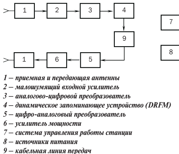
Рис. 3. Структурная схема станции ретрансляционных помех с временной развязкой
