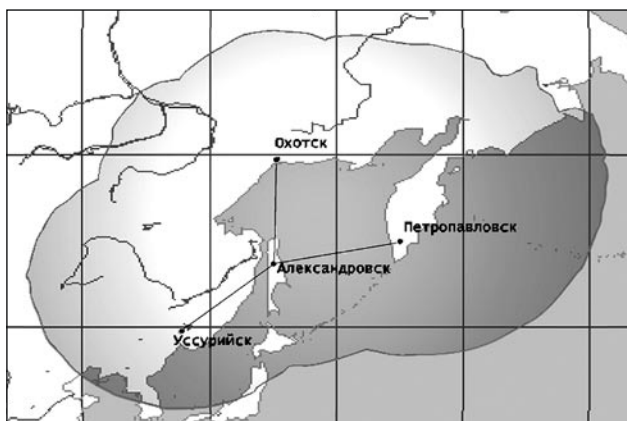
Рис. 1. Расчетная рабочая зона региональной дифференциальной подсистемы ГНСС на базе четырех станций Восточной цепи ИФРНС «Чайка» (без учета влияния перекрестных помех)
