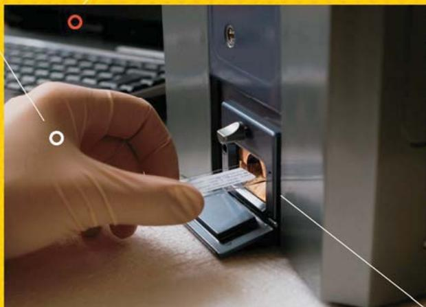
Анализатор биочипов состоит из оптико-электронного блока, системы лазеров для возбуждения флуоресценции и оптической части, совмещенной с CCD-камерой, которая передает изображение чипа на компьютер, где сигналы в каждой ячейке вычисляются и анализируются по определенному алгоритму
