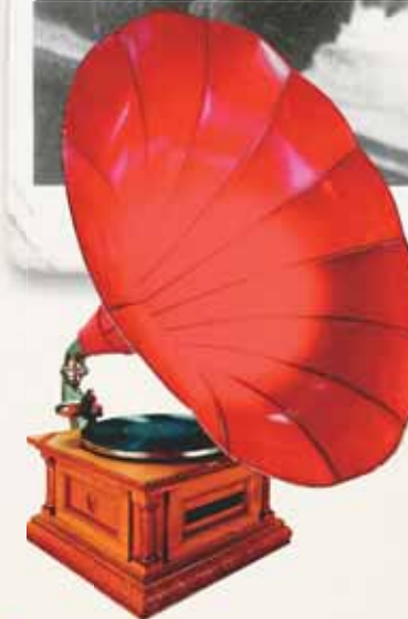
Граммофон настольный «Монарх-13». Время работы при одном полном заводе пружины составляет 4 мин. Германия, 1906–1908 гг.
