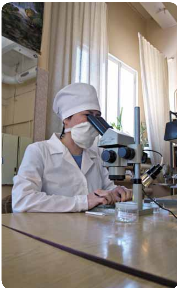
На участке обработки монокристаллов ДТГ-4 производится первичная разбраковка заготовок детекторов по чувствительности, геометрическим размерам, массе и качеству поверхности
