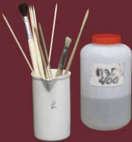
«Скорая помощь» — набор археолога для полевой консервации мокрой деревянной основы лакированных предметов водным раствором PEG-400
