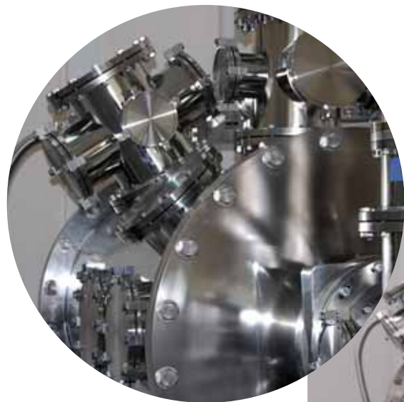
На газодинамическом вакуумном стенде-ЛЭМПУС-2 ведутся исследования плазмохимических процессов и генерации кластеров
