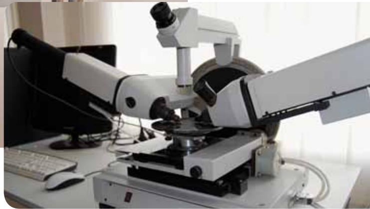
Лазерные эллипсометры используются в исследованиях тонких поверхностных слоев — от полупроводников до живых клеток
