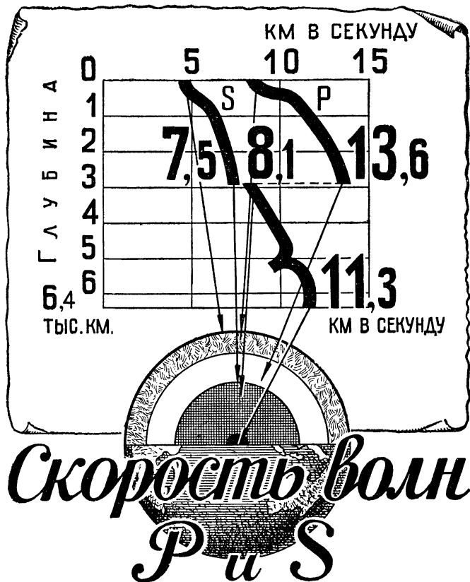
Рис. 6. Изменение скоростей продольных (P) и поперечных (S) волн внутри Земли.
