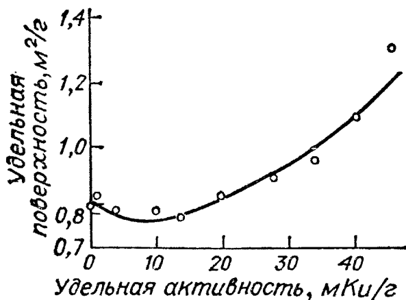
Рис. 36. Зависимость удельной поверхности образцов \text{MoO}_3 от удельной активности.
