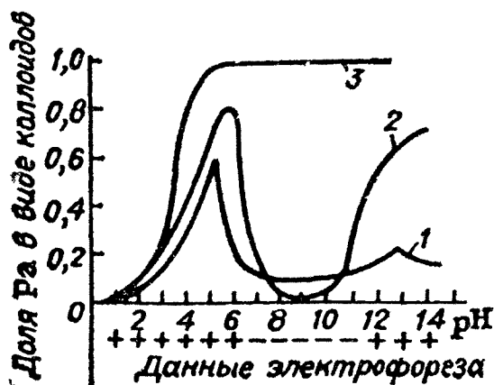
Рис. 9. Зависимость состояния протактиния-233 при концентрации \approx 10^{-12} моль/л от pH раствора:
