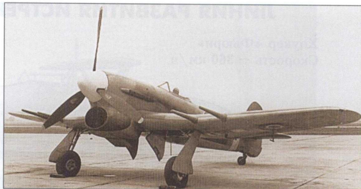
Модернизированный «Тайфун» с каплевидным фонарем кабины пилота
