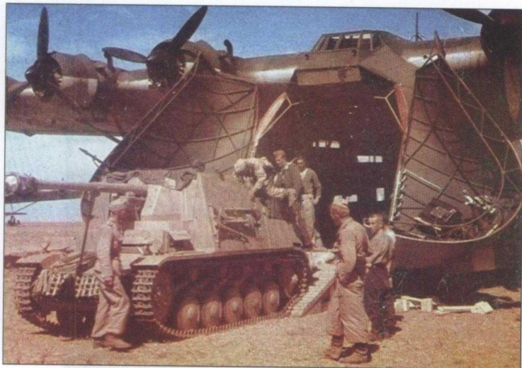
Благодаря небольшому весу «Мардеры» можно было перебрасывать по воздуху на тяжелых транспортных самолетах
