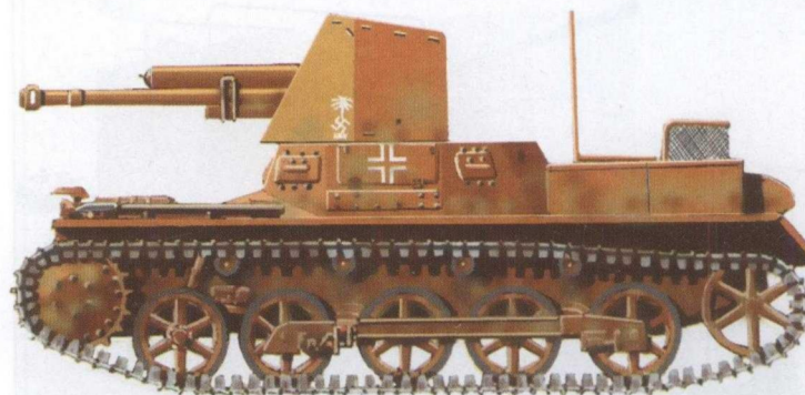
«Панцерягер I», вооруженный чешской 47-мм пушкой
