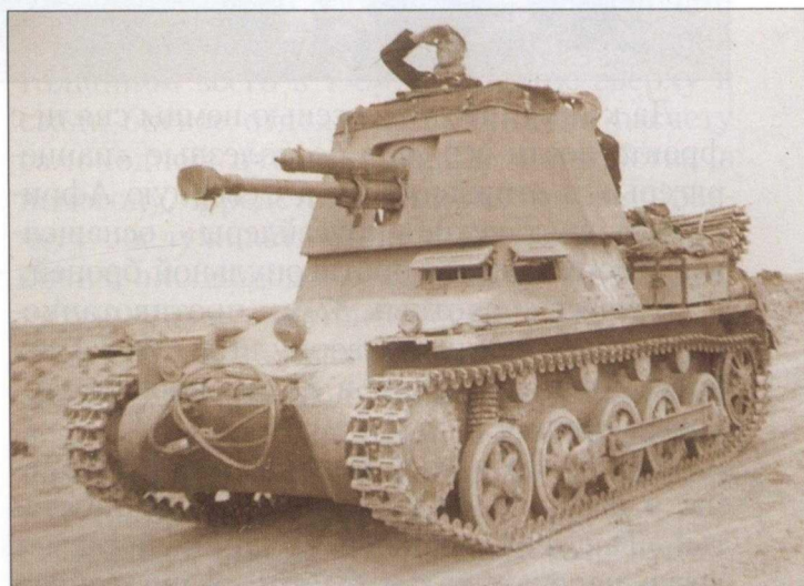
«Панцерягер I», вооруженный чешской 47-мм пушкой
