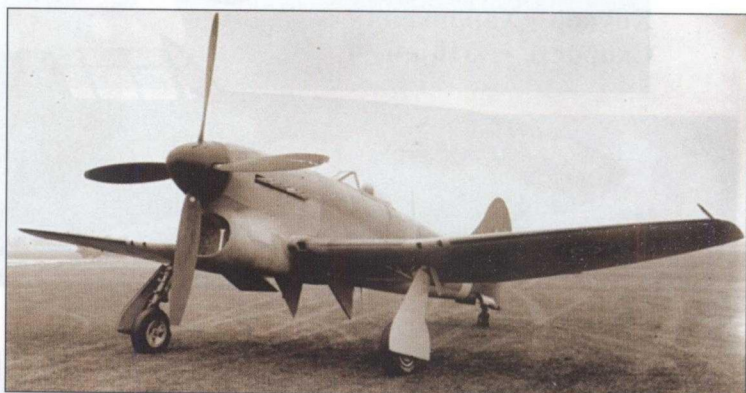
Истребитель Хоукер «Темпест». Заметно, что его крыло тоньше, чем у «Тайфуна»
