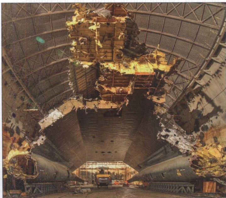
Корабль утилизировали в том же крытом доке, что и строили. Дело в том, что его «невидимое покрытие» черного цвета было очень токсичным. На открытом воздухе такие работы проводить было опасно
