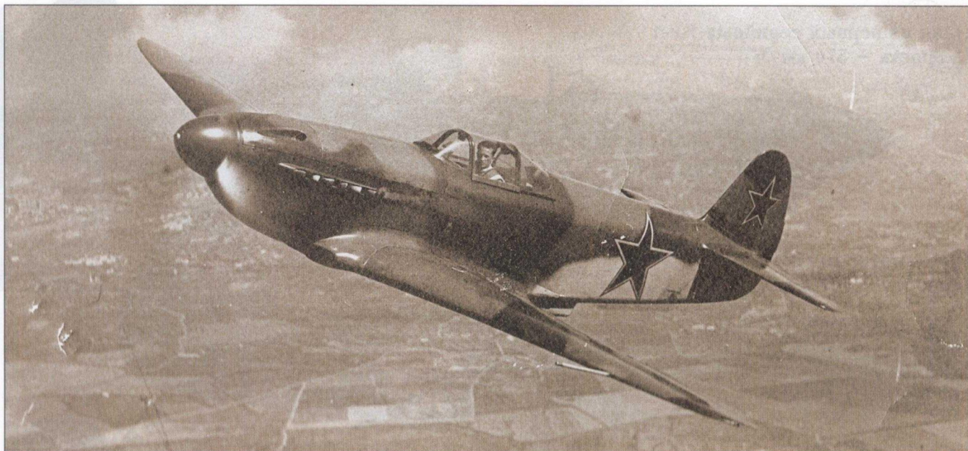
В воздухе летчик Виктор Расторгуев на истребителе Як-3 с двигателем ВК-105ПФ2
