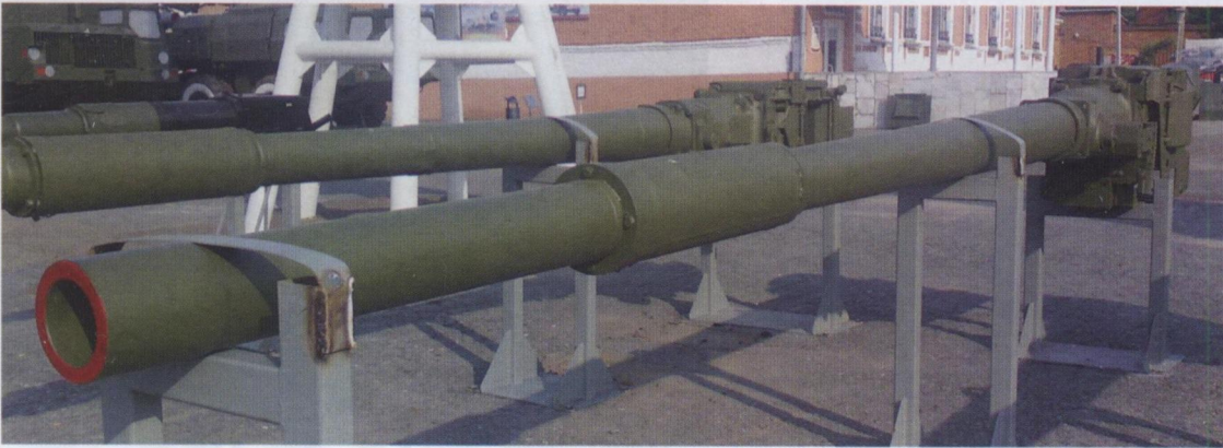
Танк Т-62 отличался от Т-55, в первую очередь, 115-мм гладкоствольной пушкой «Молот»
