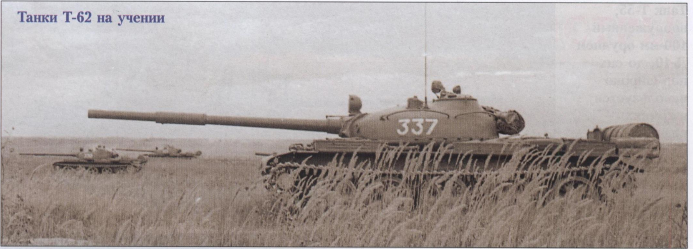
Танк Т-62 отличался от Т-55, в первую очередь, 115-мм гладкоствольной пушкой «Молот»
