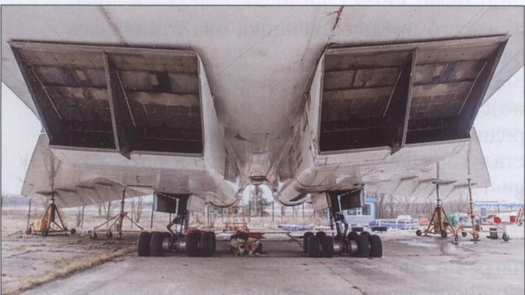
Гондолы двигателей серийного Ту-144 были разнесены. Новые короткие стойки шасси убирались в отсеки между воздухозаборниками
