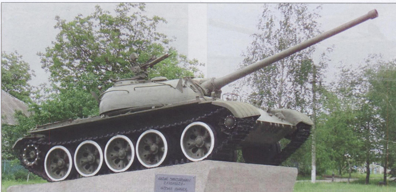
Первые отечественные танки со стабилизатором вооружения также имели противовес на пушке. Потом от противовеса отказались (на фотографии запечатлен танк Т-54)
