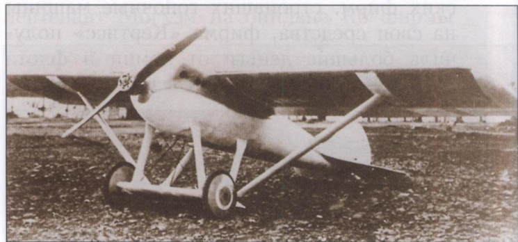
Усовершенствованный «Сесквиплан», с крыльевыми поверхностными радиаторами, установивший мировой рекорд скорости 375 км/ч
