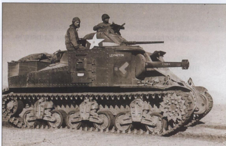
М3 – первый танк, оснащенный стабилизатором вооружения. Обратите внимание на груз, укрепленный на стволе пушки. Он уравнивал механизм стабилизатора
