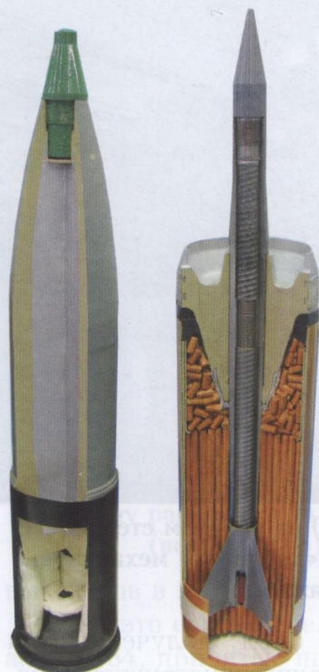
Осколочно-фугасный и подкалиберный снаряды для 125-мм пушки в разрезе. «Стрела» броневой снаряда окружена дополнительным пороховым зарядом
