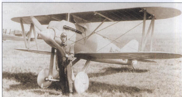
Кертисс CR-2 «Нэви-Рэйсер» уже без радиаторов Ламблена. Радиаторы перенесены на верхнее крыло
