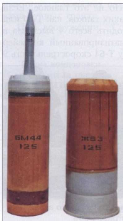
Выстрел раздельного заряжания для 125-мм пушки: справа – заряд, слева – подкалиберный снаряд в сгораемой гильзе
