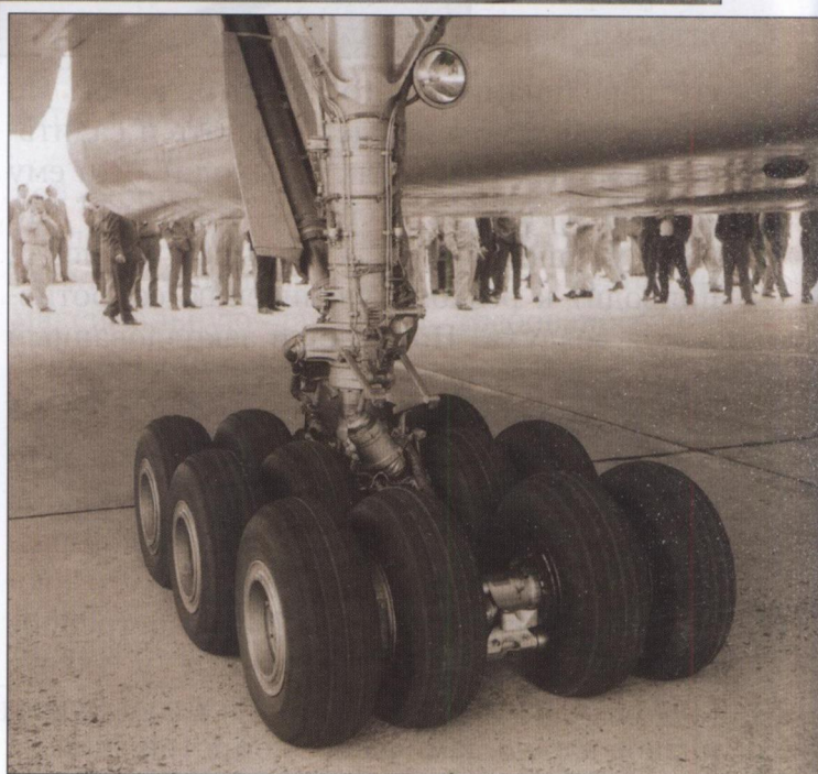
Основная стойка шасси первого Ту-144
