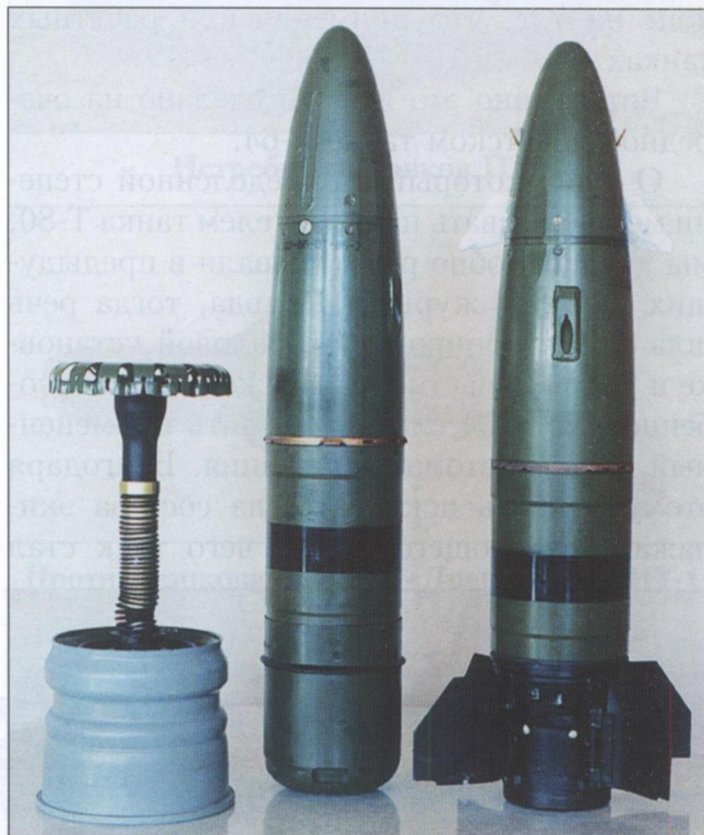
Особенностью отечественных танков является использование управляемых снарядов – наследие ракетного танка ИТ-1. Слева – вышибной заряд, в центре – управляемый снаряд «Рефлекс» в транспортном положении, справа – снаряд в положении после выстрела с раскрытыми стабилизаторами и рулями
