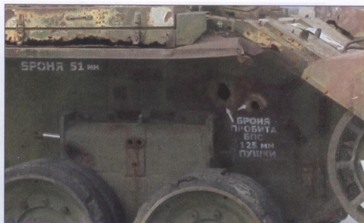
В борту «Центуриона» видны две пробоины от 125-мм снарядов танковой пушки. Обратите внимание на отличную кучность попаданий
