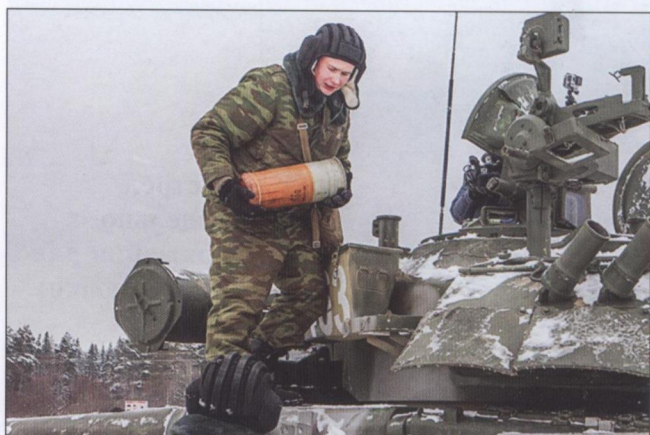
Погрузка выстрелов раздельного заряжания в танк Т-80
