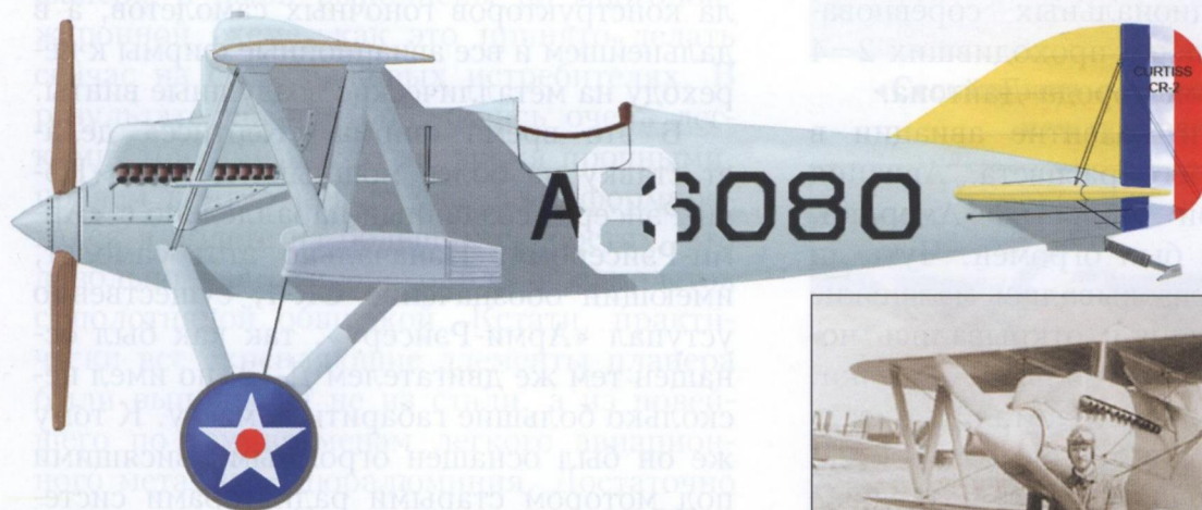
Кертисс CR-2 «Нэви-Рэйсер» уже без радиаторов Ламблена. Радиаторы перенесены на верхнее крыло
