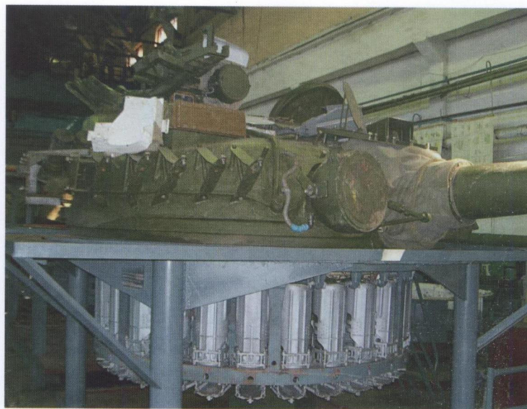
Башня танка Т-80 на учебном стенде. Под башней видна «карусель» механизма заряжания
