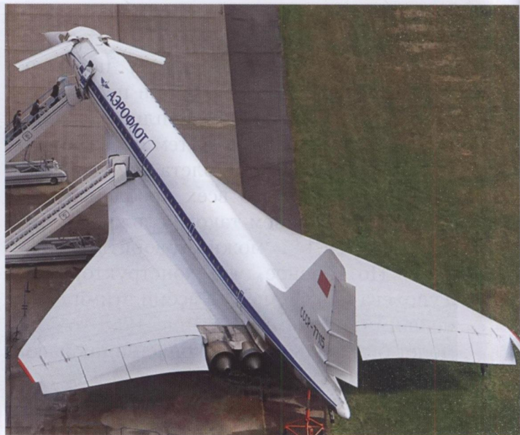
Серийный Ту-144 с прямыми кромками крыла и носовым «крылышком»
