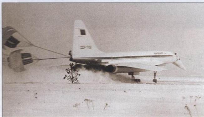
Первый серийный Ту-144 прибывает в авиационный музей в Монино, выполняя посадку с помощью тормозных парашютов
