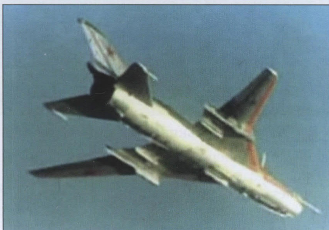
С-22И – первый в нашей стране самолет с крылом изменяемой стреловидности в полете (прототип истребителя-бомбардировщика Су-17)
