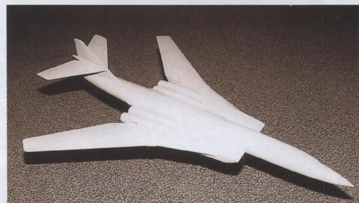
Модели самолета «160» с различными вариантами расположения двигателей — пример поиска оптимальной компоновки
