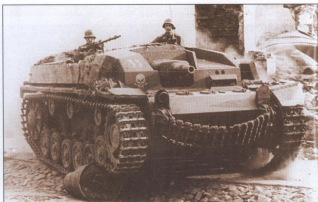
До 1942 года германские штурмовые орудия вооружались короткоствольными 75-мм пушками
