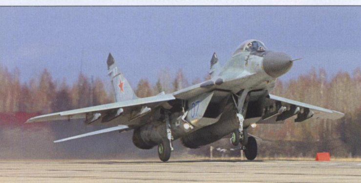
Так при взлете МиГ-29 автоматически открываются створки воздухозаборников двигателей
