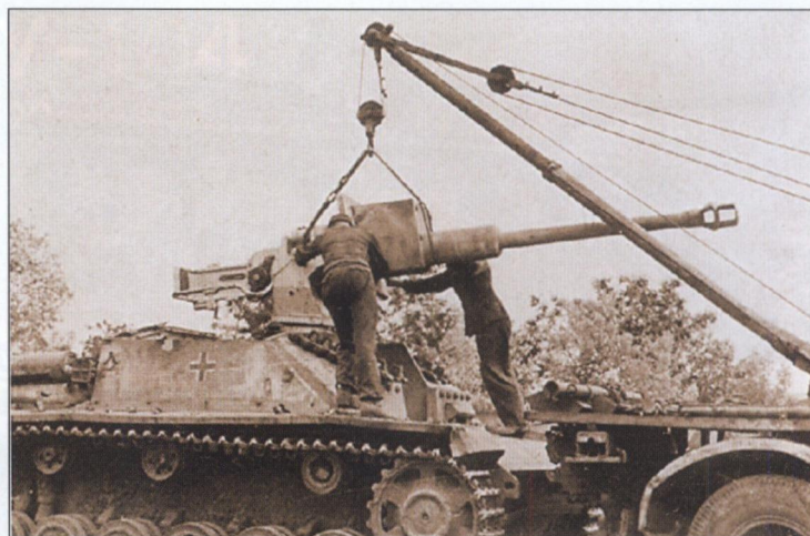
Замена пушки на «Штурмгешутце»
