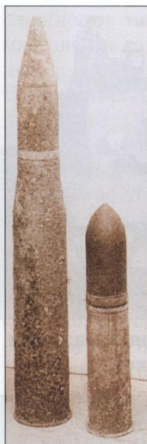
Снаряды калибра 75 мм для длинноствольной и короткоствольной пушки «Штурмгешутца». Справа – отражение атаки германских самоходок в ходе Курской битвы
