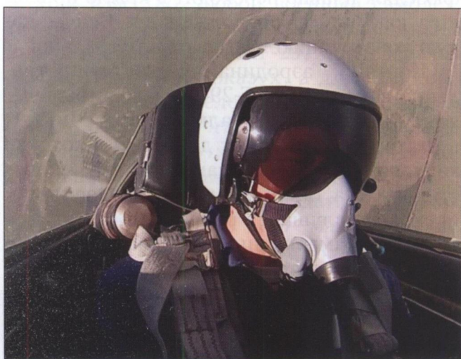
На шлеме пилота МиГ-29 установлены специальные оптические датчики, которые направят ракету туда, куда смотрит пилот
