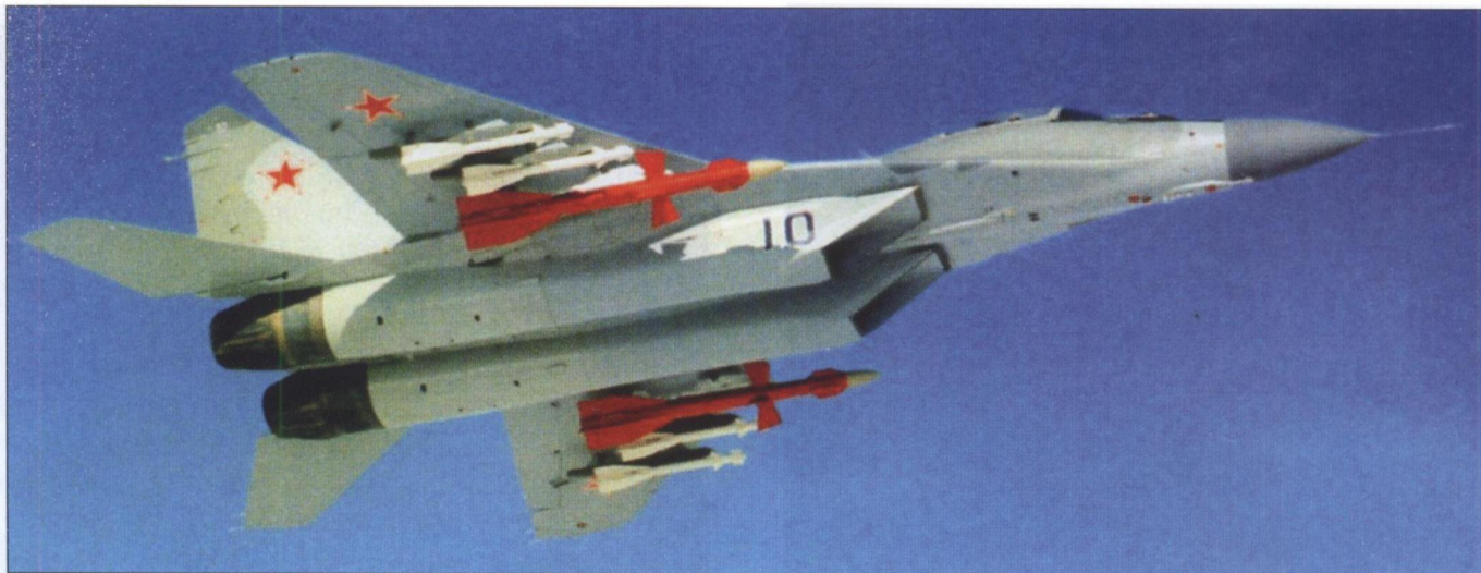
Один из первых опытных истребителей МиГ-29. Уже тогда самолет получил ракеты «воздух-воздух» средней дальности Р-27 (на фото они красного цвета). На F-16 подобное оружие появилось только через 25 лет
