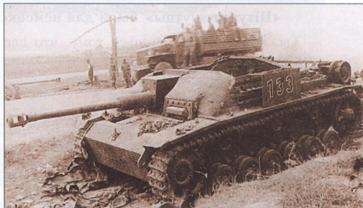
Обратите внимание на то, что лоб рубки этой подбитой самоходки залит цементной подушкой
