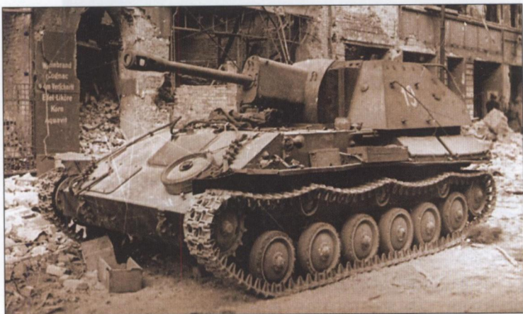
Советская самоходная установка Су-76 была создана для тех же целей, что и «штурмгешутц» – для поддержки пехоты, но в качестве «безбашенного танка» ее использовать было нельзя из-за тонкой брони
