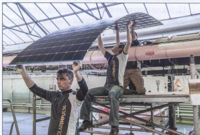
Установка солнечных батарей на верхнюю поверхность крыла «Солар Импульса»
