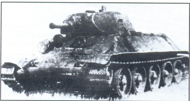
Танк А-32 – прототип Т-34 с чисто гусеничным двигателем
