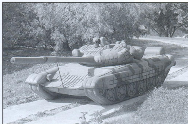
Современный надувной макет танка Т-72
