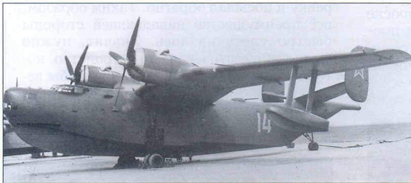
На послевоенном противолодочном гидросамолете Бе-6 также предусматривалась подвеска торпед, хотя это было его не основное оружие
