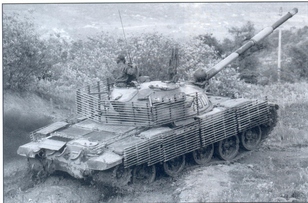
Танк Т-62, оснащенный современными решетчатыми бортовыми экранами
