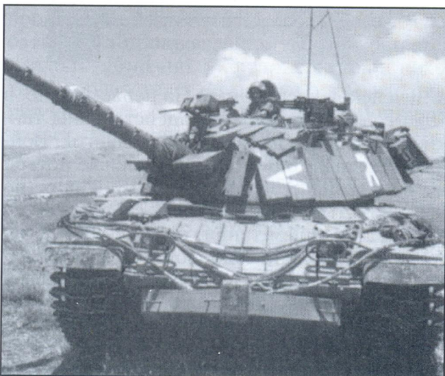
Израильский М48. Это первый танк, на котором динамическая защита была использована в бою
