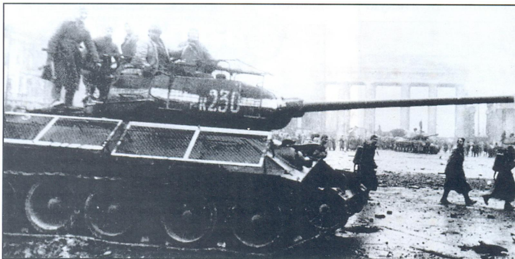
Редкая фотография Т-34, оборудованного сетчатыми экранами
