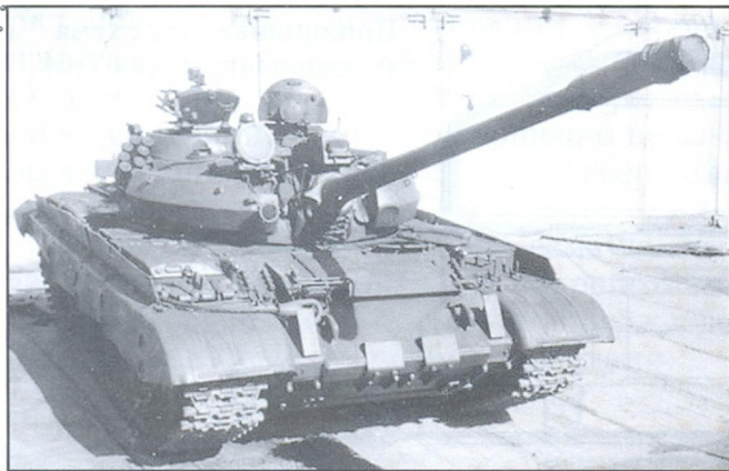
В 1970 - 1980-х годах был разработан вариант модернизации танка Т-55АМ с установкой новой накладной брони
