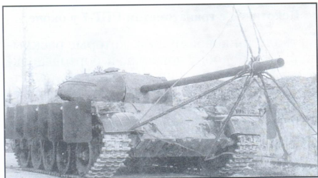
Танк Т-54, оборудованный «Зонтиком» — раскрывающимся сетчатым экраном на пушке и поворотными бортовыми щитками
