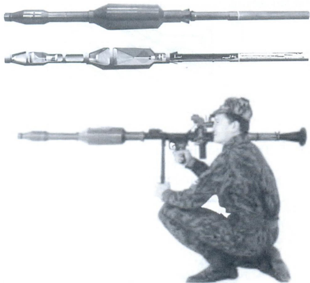
Тандемная кумулятивная граната для гранатомета РПГ-7 (общий вид и разрез) и способ стрельбы с ее помощью
