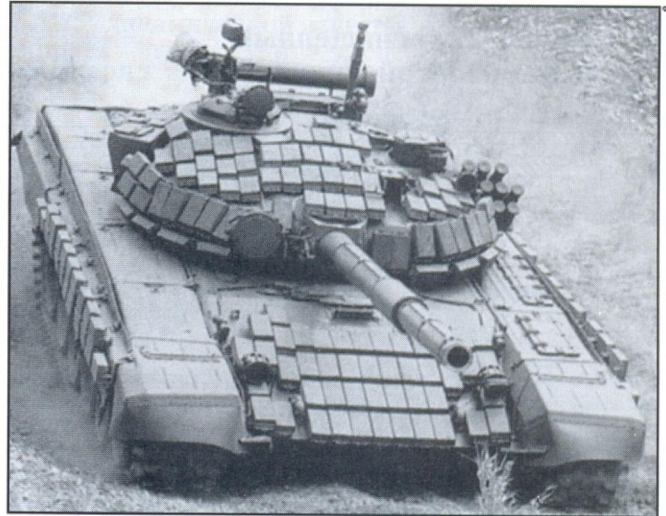
Танк Т-72, оборудованный «коробочками» динамической защиты первого поколения
