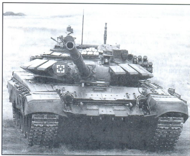
Модернизированный танк Т-72. «Коробочки» динамической защиты первого поколения заменены встроенной динамической защитой с метательными пластинами
