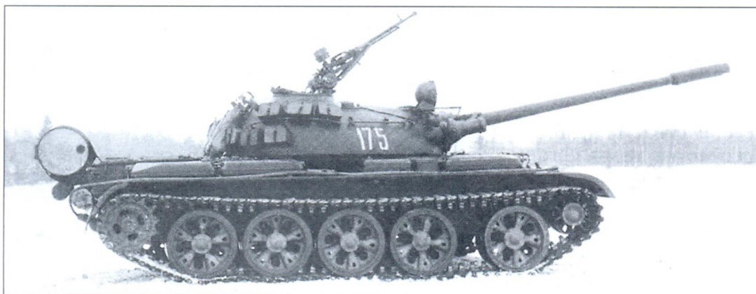
Т-54 с полусферической башней. Усовершенствованный вариант этого танка с системой защиты от оружия массового поражения получил обозначение Т-55
