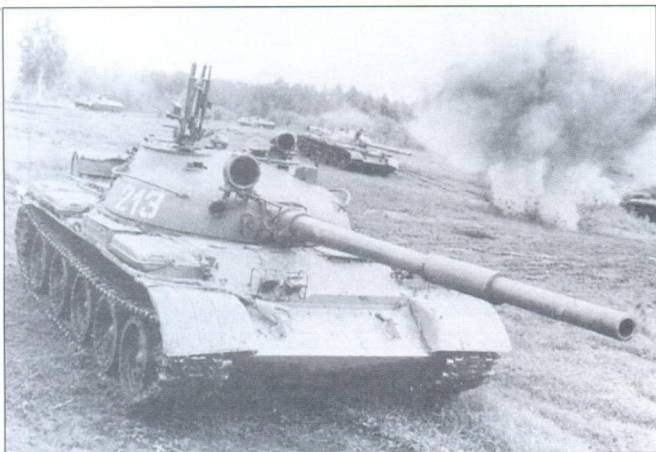
Т-62 принципиально отличался от Т-54 установкой новой гладкоствольной 115-мм пушки
