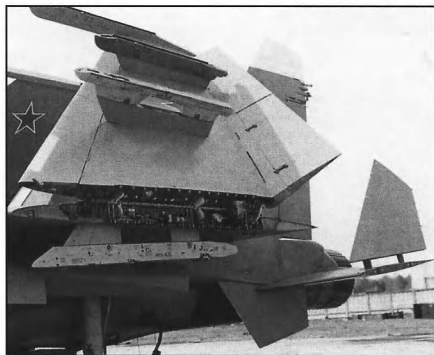
Сложенное крыло и стабилизатор Су-27К
