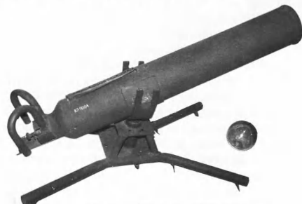
Ампуломет и стеклянная ампула с зажигательной смесью
