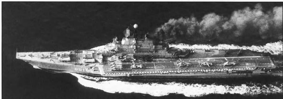
Авианесущий крейсер "Киев" (корабль проекта 1143). На взлетной палубе видны вертолеты и штурмовики Як-38
