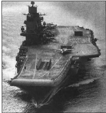
ТАКР "Адмирал Кузнецов". Обратите внимание на открытые на палубе люки ракетных пусковых установок
