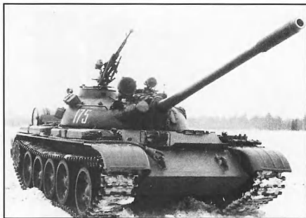
Огнемётный танк на базе Т-55. Огнемёт установлен в башне справа от пушки.
