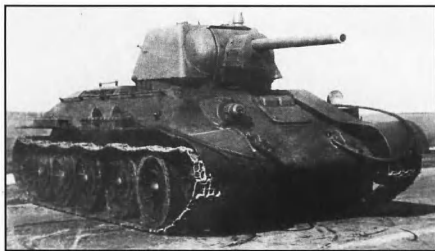
Огнеметный вариант знаменитого танка Т-34
