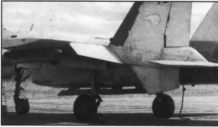
Механизация крыла стандартного Су-27 — всего лишь один флаперон (элерон-закрылок)
