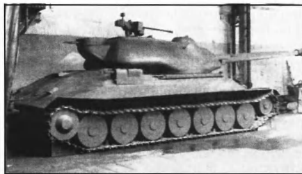
Проектный чертеж и деревянный макет танка ИС-7. Обратите внимание на поворотную пулеметную спаренную установку, размещенную в кормовой части башни
