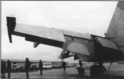
Развитая механизация крыла Су-27К включает двухсекционный двухщелевой закрылок и зависающий элерон
