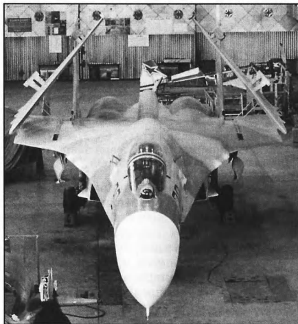
Отработка складывания крыла и стабилизатора на макете самолета
