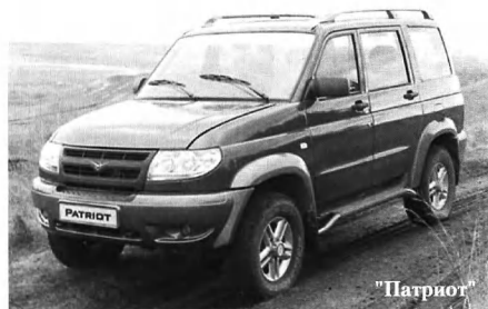
Mercedes «Гелендваген» и УАЗ «Патриот» — пример классических современных джипов, у которых жесткий металлический кузов поставлен на мощную стальную раму. Оба этих автомобиля с «честным» полным приводом являются примером для подражания в плане проходимости по бездорожью
