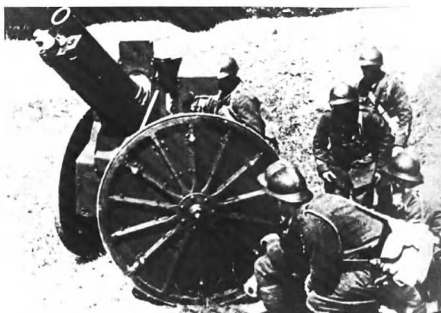
Французская пушка со стальными колесами, поворачиваемыми вместе со станинами
