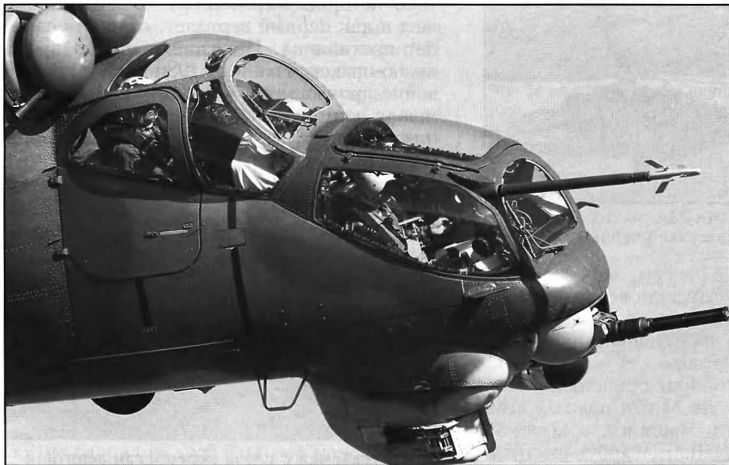
Вид на носовую часть Ми-24В. Впереди кабина борт-стрелка, за ней кабина пилота. В носовой части на подвижной турели установлен крупнокалиберный четырехствольный пулемет, а также прицельный комплекс для наведения управляемых ракет.
