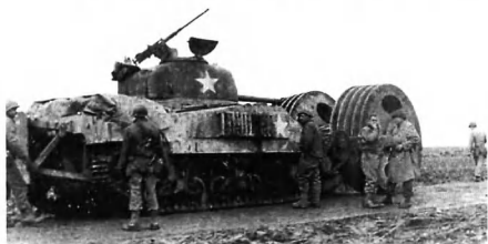
Танк "Шерман" с огромным катковым минным тралом "Тетушка Джемейма"
