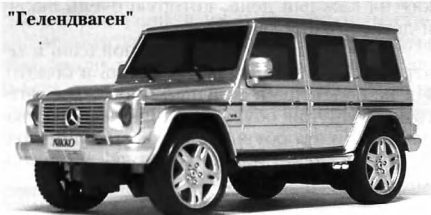
Mercedes «Гелендваген» и УАЗ «Патриот» — пример классических современных джипов, у которых жесткий металлический кузов поставлен на мощную стальную раму. Оба этих автомобиля с «честным» полным приводом являются примером для подражания в плане проходимости по бездорожью
