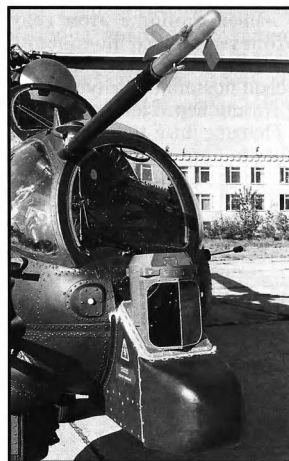
В носовой части доработанных Ми-24 появились приборы ночного видения, сделавшие применение вертолета всепогодным
