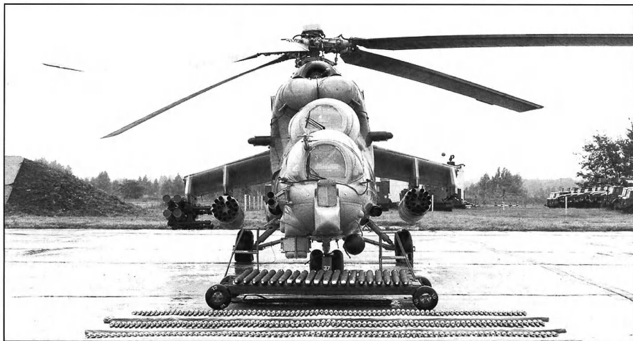
Модернизированный Ми-24П. Перед вертолетом выложены 30-мм снаряды и 80-мм ракеты. Обратите внимание на интересную особенность Ми-24: его фюзеляж несимметричен, а ось винта наклонена влево на 2,5 градуса
