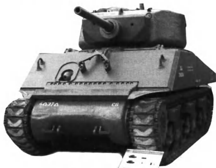
Специально для прорыва вражеской обороны был создан "Шерман-Джамба" с усиленной броней толщиной 10 см
