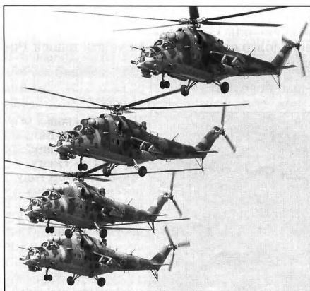
Модернизированные вертолеты Ми-24П российской армии, оборудованные приборами ночного видения и неубираемым шасси
