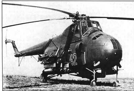
Ми-4 – первый отечественный вооруженный вертолет с пилонами для ракет
