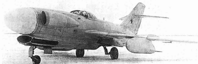
Насколько сложной была проблема размещения локатора показывает то, как менялся воздухозаборник на опытном перехватчике Ла-200
