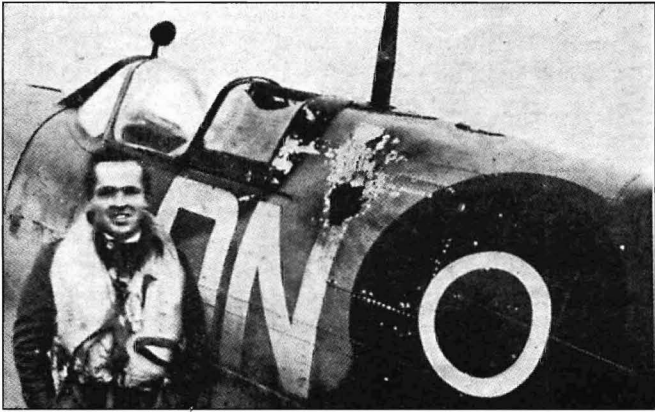
Попадание 20-мм снаряда в фюзеляж за кабиной пилота. Хорошо, что это был не "Спитфайр" VIII
