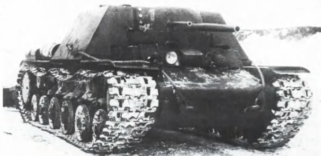
КВ-6 с 76-мм пушкой и двумя 45-мм пушками в неподвижной рубке
