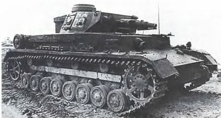
Немецкий танк "Панцер-IV". Пушка калибра 75 мм (в начале войны короткоствольная), броня — 20-30 мм.
