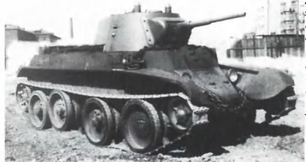
Советский легкий танк начала войны БТ-7 Пушка калибра 45 мм. Броня — 15-22 мм.
