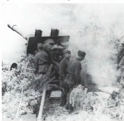
Успех СУ-152 во многом был обязан мощной 152-мм пушке-гаубице МЛ-20 образца 1937 г. Именно эти орудия первыми открыли огонь по территории Германии в 1944 г. В течение всей войны немцы безуспешно пытались создать 150-мм гаубицу с дальностью стрельбы 18 км специально для борьбы с МЛ-20
