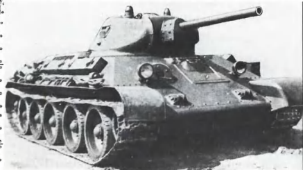
Советский средний танк Т-34. Пушка калибра 76 мм. Броня — 45 мм.
