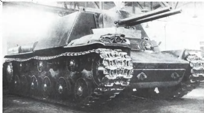
КВ-7 с двумя 76,2-мм пушками
