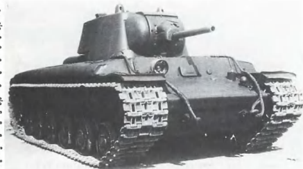
Советский тяжелый танк КВ Пушка калибра 76 мм. Броня — 75 мм.
