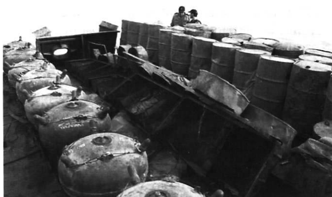
Пример маскировки минного заградителя: мины на палубе этого корабля закрывают разрезанными пополам бочками
