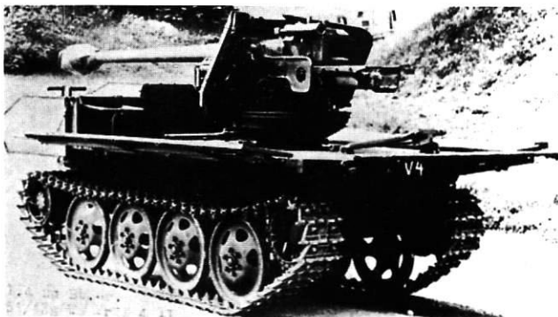
«Ост» в боевом положении. Борты кузова откиннуты. Получилась ровная площадка для работы артиллерийского расчета
