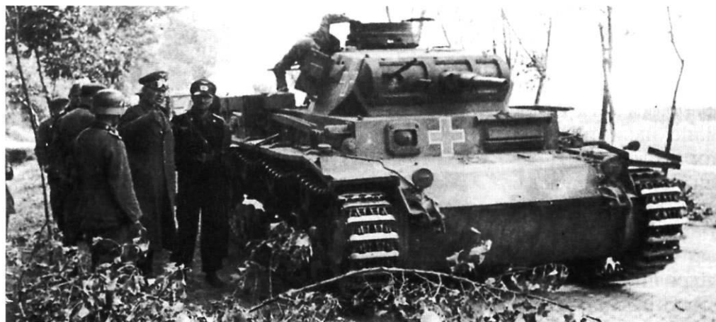
Командирский танк "Панцер III". Пушка – всего лишь макет
