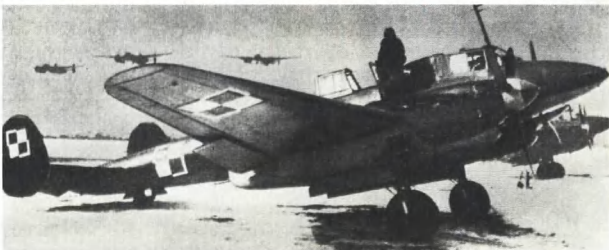
Учебный бомбардировщик Пе-2У со второй кабиной для инструктора. Самолет из состава польской авиачасти
