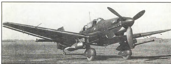
"Противотанковый" Ju 87G с 37-мм пушками под крылом
