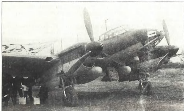
Разведчик Пе-2 с дополнительными топливными баками
