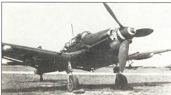
Специальный ночной бомбардировщик Ju 87D с пламегасителями на выхлопных патрубках двигателя
