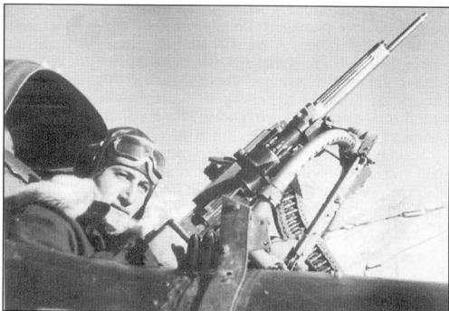
Самодельная стрелковая установка с 7,62-мм пулеметом ШКАС. Позже выпускались специальные заводские комплекты для переделки одноместных Илов в двухместные прямо на аэродромах
