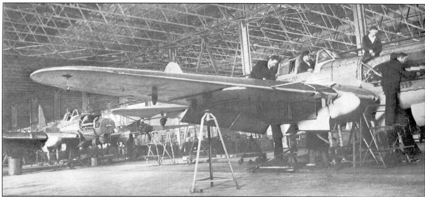
Сборка штурмовиков Ил-2 на одном из авиационных заводов
