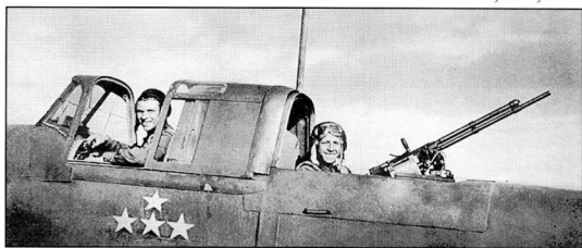
Вид на кабину стрелка с 12,7-мм пулеметом УБТ. Четыре звезды на борту – четыре сбитых вражеских самолета
