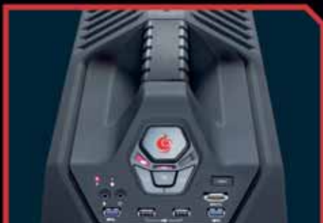
Регулировка скорости вращения корпусных вентиляторов
