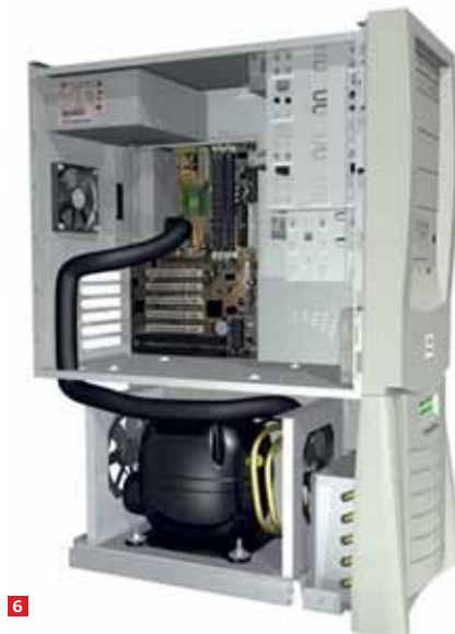
► Компьютер Super G2, выпущенный в 2001 г. фирмой KryoTech, основан на 1,4-ГГц Athlon, разогнанном до 1866 МГц
