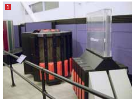
► Cray-2 с системным блоком, полностью залитым охлаждающей жидкостью
