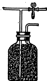
Рис. 174. Банка с углем для поглощения избытка хлора.
