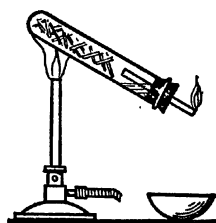
Рис. 259. Термическое разложение древесины (лабораторный опыт).
