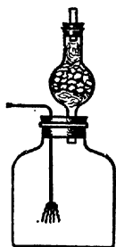
Рис. 187. Сжигание меди в хлоре.
