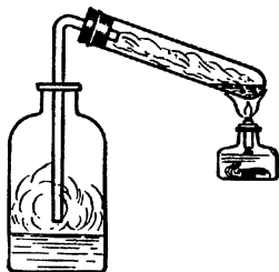
Рис. 208. Получение паров брома.
