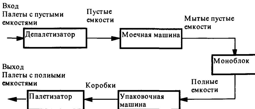
Рис. 4.14.5. Структура линии упаковки жидкостей
