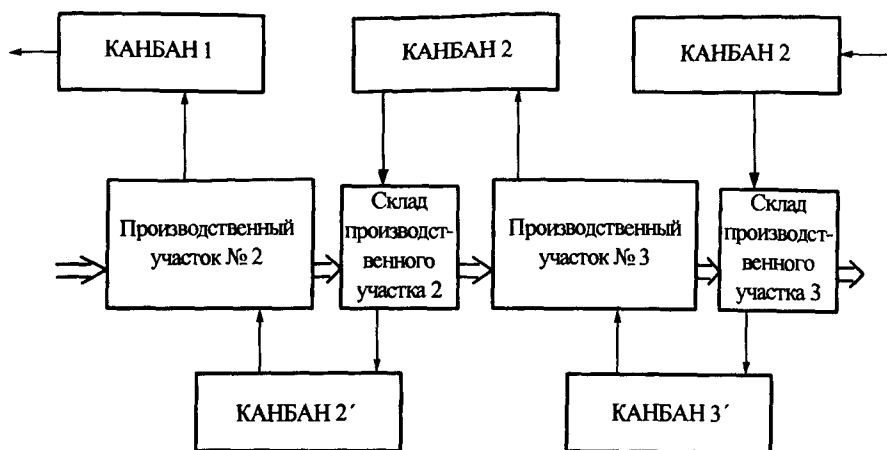
Рис. 3.2.3. Управление производством по системе КАНБАН:
