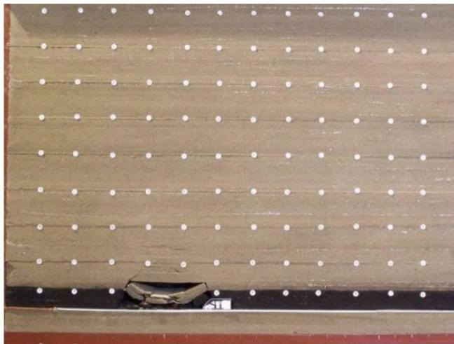
**Рис.1. Первичное обрушение кровли в забое**
