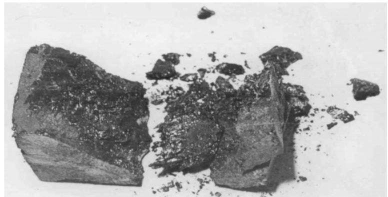
Рис.1. Вид разрушения образца горной породы при нагружении «обобщенным» сдвигом ( $\mu_\sigma=0$ )
