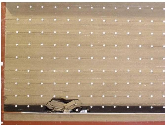
**Рис.2. Обрушение кровли на расстоянии 80 м от начала выработки до забоя**
