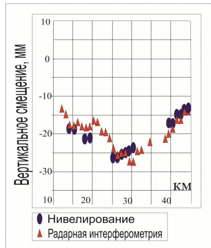
**Рис. 6. Сопоставление результатов измерения вертикальных смещений земной поверхности по данным повторного нивелирования и PCA интерферометрии на Гронингенском газовом месторождении**
