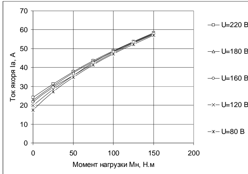
Рисунок 4.11 – Зависимость тока якоря от нагрузки двигателя МП-32 при различных напряжениях питания
