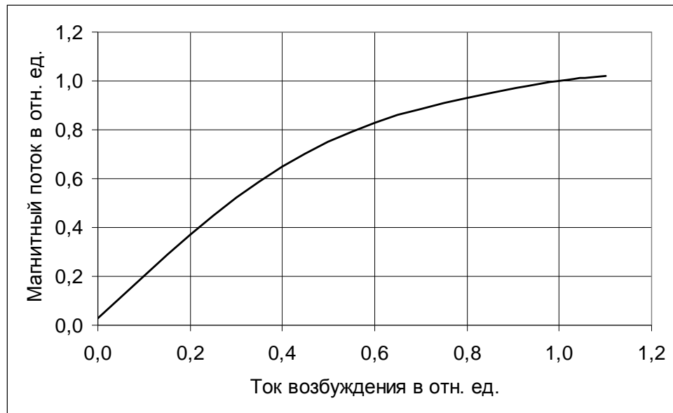
Рисунок 4.20 – Универсальная кривая намагничивания для машин типа ПН и МП параллельного возбуждения
