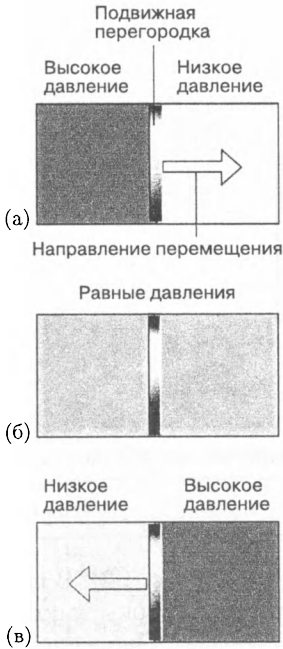
Рис. 1.1. Области высокого и низкого давления разделены подвижной перегородкой, которая может перемещаться вправо или влево (а) и (в). В случае, когда оба давления одинаковы, поршень покоится (б). Это пример механического равновесия двух систем.
