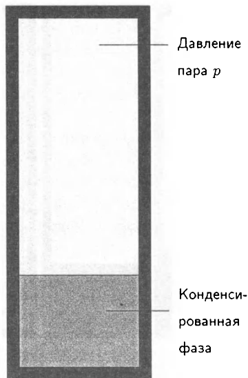
Рис. 6.2. Давление насыщенного пара жидкости или твердого вещества — это давление пара, находящегося в равновесии с конденсированной фазой.
