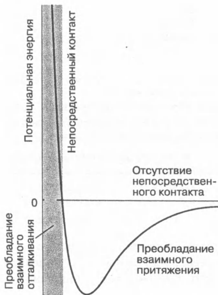
Рис. 1.12. Зависимость потенциальной энергии двух молекул от расстояния между ними. При сближении молекул на очень малые расстояния преобладают силы отталкивания (большие положительные значения потенциальной энергии). При умеренном удалении молекул друг от друга потенциальная энергия отрицательная, преобладают силы притяжения. Если расстояние между молекулами велико (правая граница графика), потенциальная энергия близка к нулю и взаимодействие отсутствует.
