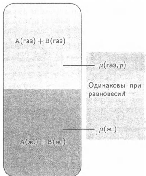
Рис. 7.9. При равновесии химические потенциалы вещества А в газовой и конденсированной фазах равны друг другу. Равенство сохраняется и в присутствии растворенного вещества. Так как химический потенциал А в паровой фазе зависит от его парциального давления, химический потенциал жидкого вещества А может быть выражен через парциальное давление его пара.
