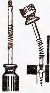
**ГИБКАЯ ОТВЕРТКА.** Часто бывает нужно завинтить болт, гайку или винт, расположенные в труднодоступных местах. Обычной отверткой в таких случаях много не поработаешь, нужна особая.
