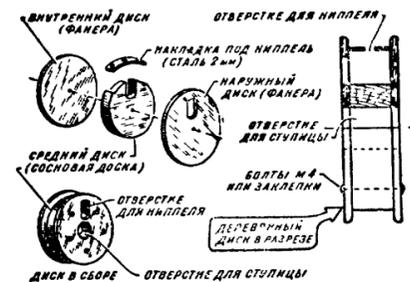
Рис. 10. Изготовление деревянных дисков колес
